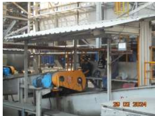
รูปที่ 13 รังลำเลียงถั่ว (ติดตั้งอุปกรณ์การฉีดพรมถั่วไว้ด้านใน)
