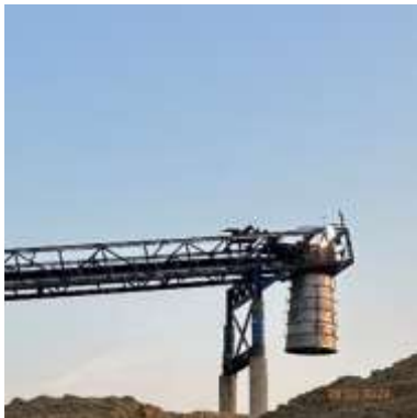
รูปที่ 6 ท่อ Chute ต่อจากสายพานลำเลียง ขานอ้อย
