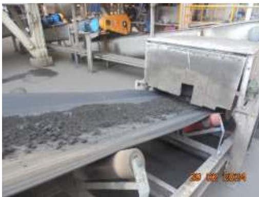
รูปที่ 13 รังลำเลียงถั่ว (ติดตั้งอุปกรณ์การฉีดพรมถั่วไว้ด้านใน)
